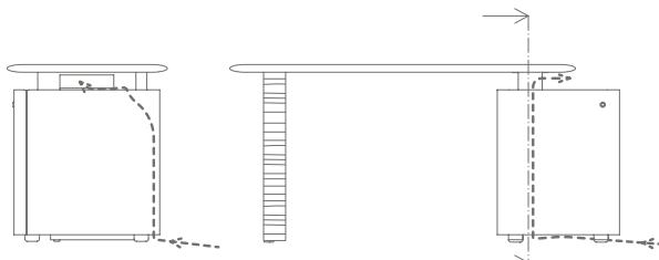
Il passaggio cavi avviene tramite uno sportellino sulla colonna di collegamento tra storage unit e piano.
