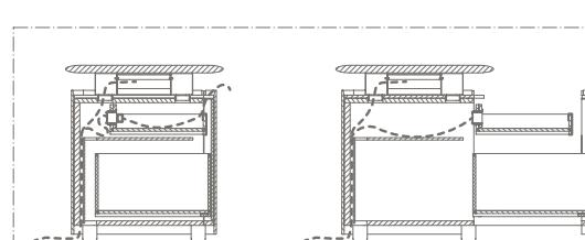
Il passaggio cavi avviene tramite il cassetto superiore portaprese. In questo caso i cavi elettrici provenienti dal cassetto possono uscire e passare attraverso una fessura del piano della cassettiera.
